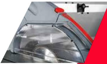
**AJUSTE Y REEMPLAZO:** de sierras con una llave de boca (no hexagonal, CÓMODO Y FÁCIL).
