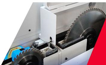
**PINZAS ESPECIALES:** El empujador está equipado con pinzas neumáticas, lo que garantiza una fijación confiable de las piezas a cortar. Siete pinzas de cuatro dedos, fijan de forma segura un paquete de material de hasta 90 mm de grosor y una hoja.
